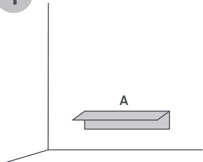
FISSARE AL MURO CON I TASSELLI IN DOTAZIONE L' ANGOLARE (A) IN MODO CHE LA BASE DEL MOBILE ED IL TOP RISULTINO ALL' ALTEZZA DA TERRA DESIDERATA. VERIFICARE CHE L'ANGOLARE (A) SIA A LIVELLO PER FARE SI CHE ANCHE LA BASE SIA A LIVELLO.
