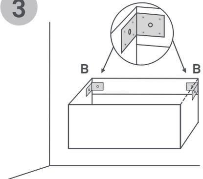
LA BASE SOSPESA È PROVISTA DI 2 ANGOLARI PREFORATI (B) A FORMA DI "L", IN ALTO, POSIZIONATI SUL TRAVERSO INTERNO.
